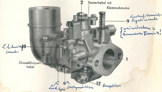
(10), die am Vergasergehäuse eingeschraubt ist, kann die Drehzahl des Motors im Leerlauf eingestellt werden. Die Verstellung, d. h. hineindrehen der Schraube, bewirkt Vergrößerung, hinausdrehen Verkleinerung der Drosselklappenspalte bzw. höhere oder niedrigere Leerlaufdrehzahl.
