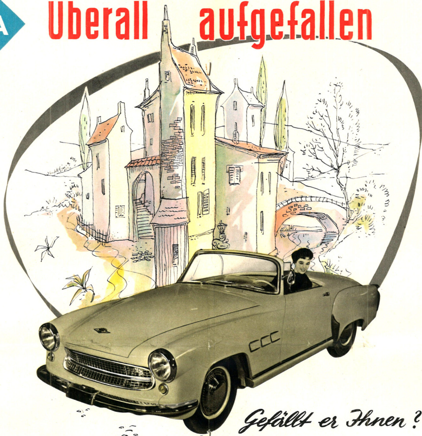
der rassist-elegante „Wartburg“-Sportwagen des VEB Automobilwerk Eisenach? Das Temperament erhält er vom 50 PS-Dreizylinder-Zweitaktmotor, auch seine 140 km/h Höchstgeschwindigkeit. Der Sportweitzer kann mit versenkbarem Verdeck aber auch als Coupé gefahren werden.
